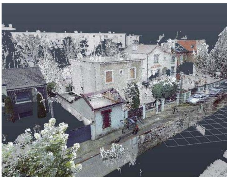
*Pour cette opération, No Man's Land a réalisé un scan 3D de l'existant, en louant un scanner. Du nuage de points, l'Agence a tiré une maquette BIM sous Revit. A laquelle elle a ajouté l'extension, la surélévation, et l'installation de VMC double flux. ©No Man's Land*
